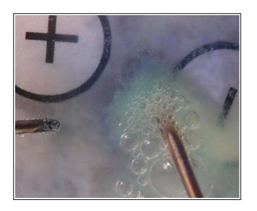
160. Se prepara la electrólisis de una disolución de bromuro sódico, al que se le ha echado una gota de azul de bromotimol (vira a azul en medio básico), con un montaje similar al dado en la foto 1(test 155). En un momento determinado se realiza una foto de dicha electrólisis, de su observación deducirás que: a) En el cátodo se deposita sodio b)En el cátodo se desprende hidrógeno c)La disolución pasa de pH7 a básico d)En el ánodo se desprende bromo
