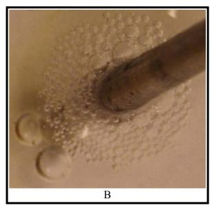
157\*. Las fotos A y B, corresponde a los electrodos empleados en la electrólisis de una disolución de yoduro potásico. En la foto A, se describe los siguientes posibles procesos:
