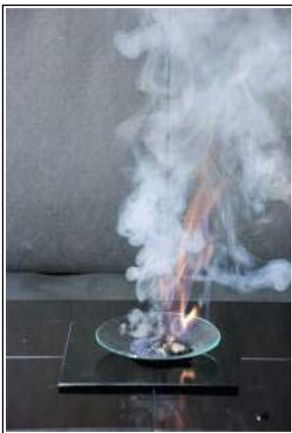
105. Como puedes observar, la reacción entre el permanganato potásico con unas gotas de glicerina es muy violenta y requiere que se haga con protección, esto es debido a que se trata de una reacción redox, con producción de gases (dióxido de carbono y agua), aunque también se produzca un residuo sólido de óxido de manganeso(III), y carbonato potásico. De esta reacción ajustada por el método ion-electrón podrás decir que:
