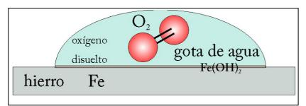
77. En el esquema dado, representa la acción de una gota de agua sobre una plancha de hierro, que le va a producir corrosión, con la formación de hidróxido de hierro(II), según lo dado y si ajustas el proceso por el procedimiento ionelectrón podrás asegurar que:
