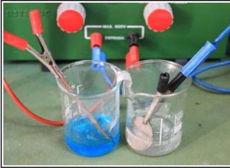
40\*. Si en la pila Daniell, sustituyéramos el electrodo de cinc, por una moneda de plata, en una disolución de nitrato de plata, tal como muestra la figura, dirás que:
