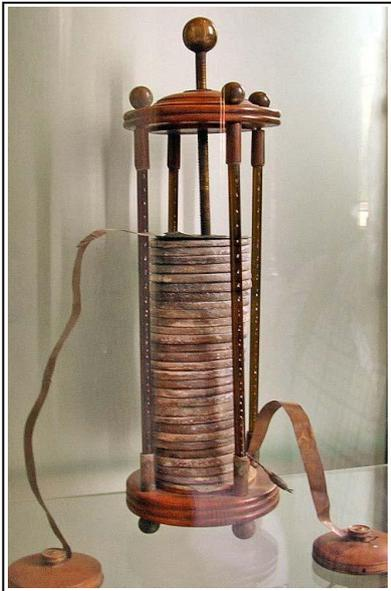
4\*. Mientras que el nombre que dio Volta al primer generador de corriente continua: *órgano eléctrico artificial*, se basaba en su comparación con los órganos eléctricos naturales del pez torpedo o de la anguila eléctrica, el que se emplea actualmente: pila voltaica o galvánica, surge del amontonamiento o apilamiento, tal como puede observarse de los elementos formados por discos de cobre o plata y estaño o cinc. De esta primera pila podrías decir que no funcionaría si los discos fueran:
