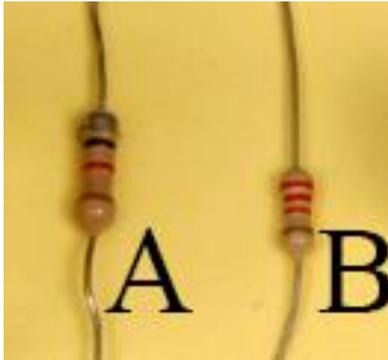
370\*. Teniendo en cuenta los códigos de colores y la figura, la diferencia entre la  $R$  equivalente de A y B, según se monten en serie o en derivación es aproximadamente en ohmios de:
