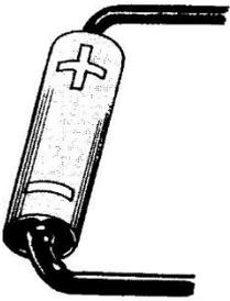
301\*. Los condensadores electrolíticos (los más usados) como el de la figura constan de una solución acuosa de un electrolito situada entre dos electrodos metálicos con una fina capa de aislante (dieléctrico), extendida sobre una lámina de aluminio, su capacidad es muy grande pero tienen el inconveniente que:
