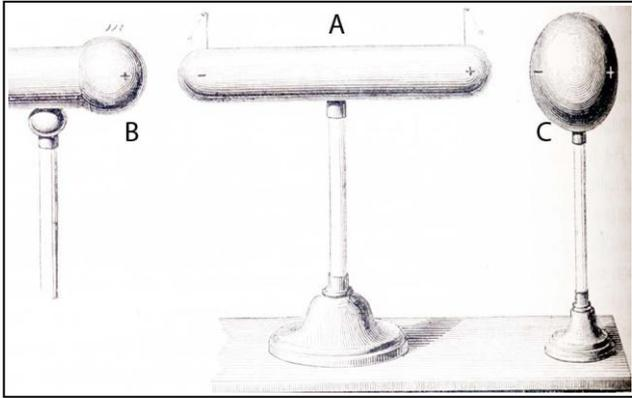
45\*. El dispositivo del test anterior se completa con un ovoide metálico C, sobre un pie aislante y otro pequeño péndulo en el otro extremo del cilindro de latón. Observando en el dibujo las consecuencias del experimento dirás que:
