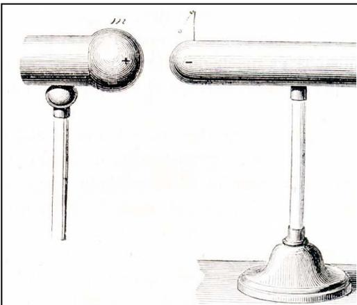
44. Aepinus en 1759, realizó el siguiente experimento: sobre un cilindro de latón aislado por un pie de vidrio, con un pequeño péndulo eléctrico en su parte superior se aproxima un cuerpo electrizado positivamente, observándose el fenómeno que se aprecia en el dibujo. Si extraes conclusiones dirás que dicho cilindro:
