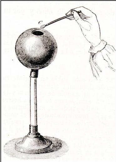
41. A finales del siglo XVIII, Coulomb tomó una esfera hueca de cobre, aislada por un pie de vidrio, con un pequeño orificio en su parte superior, tal como indica el dibujo. La esfera se electriza positivamente, y se comprueba la carga con una pequeña barrita de goma, terminada en una laminilla metálica. El asombro de Coulomb fue muy grande cuando observó que:
