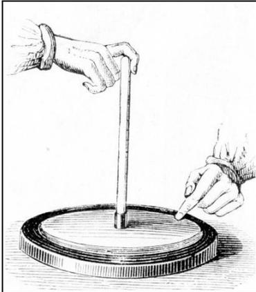
46. El físico italiano Volta, inventa en 1775, el electróforo, aparato destinado a crear carga eléctrica. Constaba de unan torta resinosa montada sobre un disco de madera unido a un mango aislante. Si se frota la resina con una piel de gato quedando cargada negativamente y se le superpone un disco de estaño (obsérvese el dibujo). Si se toca con un dedo el disco dirás que el disco:
