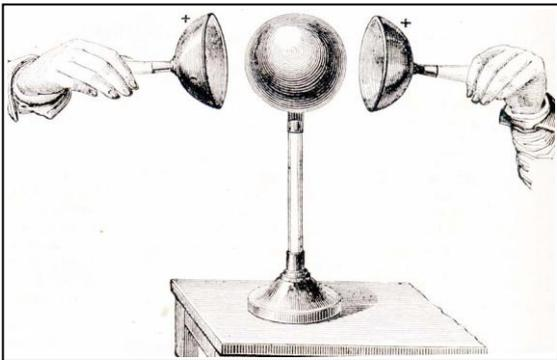
42. Otro experimento realizado por Coulomb, fue el montar una esfera de cobre, como la anterior, pero sin orificio, junto a dos semiesferas huecas que pudieran cubrirla totalmente, como se observa en el dibujo, con mangos aislantes. La esfera se electriza, y después de ser cubierta por las semiesferas observó que estas quedaban cargadas positivamente, lo que implicaba que la esfera:
