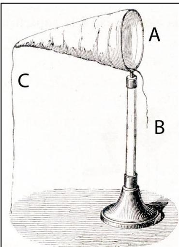
48. Faraday, realizó el siguiente experimento. Sobre un aro metálico A apoyado en un soporte aislante, montó una bolsa de tela en forma cónica Se electriza la bolsa positivamente, tirando de C, se comprueba que la carga solo está en la parte exterior de la bolsa. Se tira del hilo B, invirtiendo la bolsa de forma que la parte exterior pasa a interior y viceversa. Ahora ocurrirá que la carga positiva de la bolsa:
