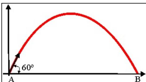
1.5.9. En un partido de fútbol, situado el balón en el punto A, un delantero lo impulsa con una velocidad de 8 m/s, formando un ángulo de  $60^\circ$  con la horizontal. Si no se tienen en cuenta la resistencia del aire ni el viento, el balón deberá llegar a B, que dista de A:
