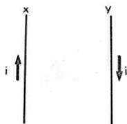
92. Dos conductores rectilíneos x e y, dados en la figura, por los cuales circula la corriente con intensidad  $i$ , pero en sentido contrario:
