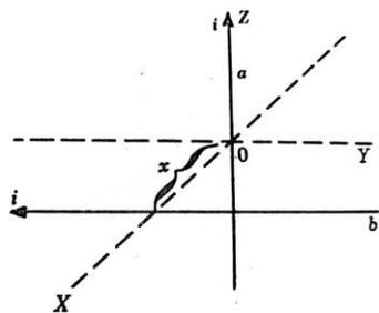
96. La figura representa dos conductores perpendiculares, el  $a$  está fijo, y el  $b$  se puede mover, y por ambos circula una corriente  $i$  en el sentido indicado, dirás que  $b$ :
