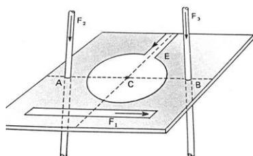
99. En la figura se dispone dos conductores paralelos  $F_2$  y  $F_3$ , y en un plano perpendicular a ellos, una espira E y otro conductor rectilíneo  $F_1$ . La corriente circula por ellos en el sentido dado, y cada uno crea un campo magnético B, en C cuyo módulo vale  $K$ . El campo magnético resultante de los cuatro conductores en el punto C valdrá:
