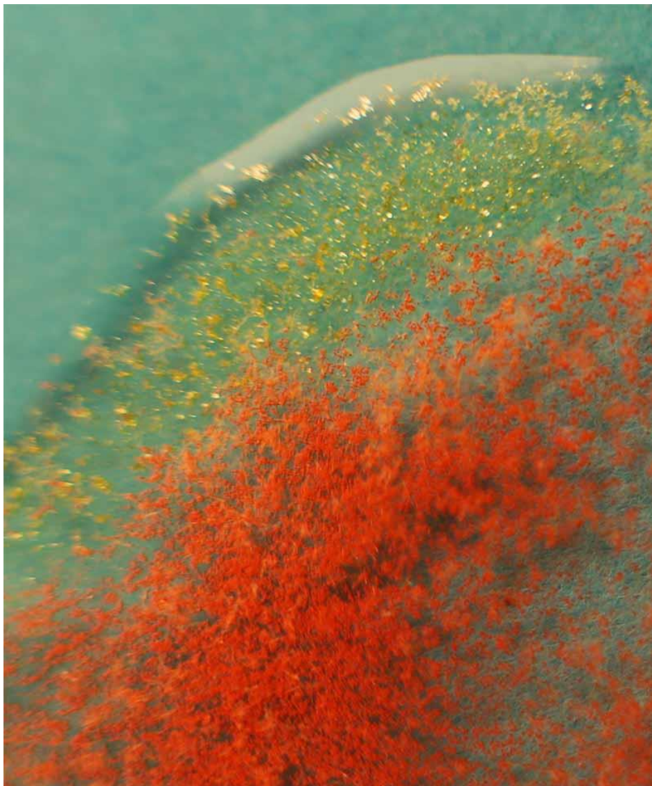
Fig.5(se le agrega una gota de nitrato de Plomo(II) Se forma un precipitado amarillento (\text{NH}_4)_2\text{HgI}_4(\text{s}) + \text{Pb}(\text{NO}_3)_2(\text{ac}) = \text{PbHgI}_4(\text{s}) + 2(\text{NH}_4)\text{NO}_3
