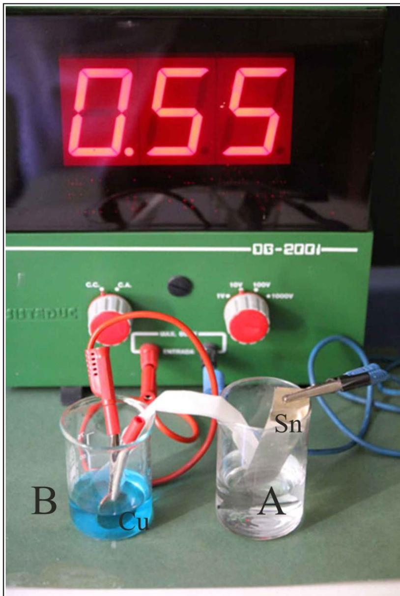
En la pila de la figura, el electrodo A, es un papel de estaño , sumergida en una sal de  $\text{Sn}^{2+}$  0.01M . Mientras que en B se dispone una moneda de cobre, en una disolución de sulfato de cobre(II). Se unen por un papel de filtro humedecido en una disolución de nitrato sódico. Conociendo los potenciales normales de reducción de los siguientes pares:
