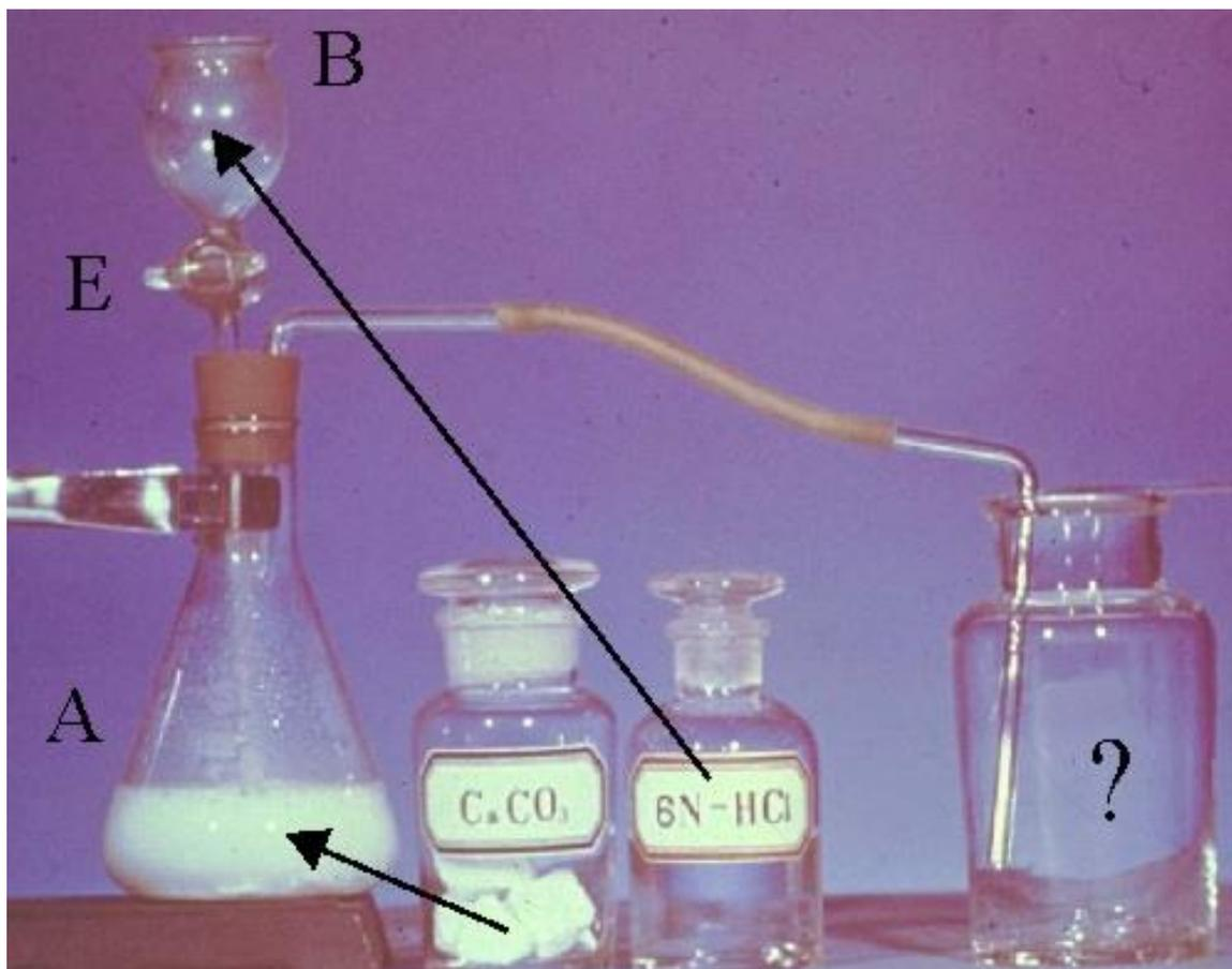
En B, se disponen 20 mL de HCl 6N y en A, una disolución saturada de carbonato de calcio. Se abre la llave E y el gas que se desprende llega al frasco de la derecha.
