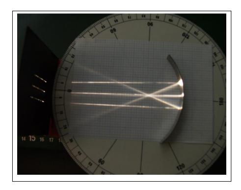
La foto representa la reflexión de un haz paralelo de luz sobre un espejo cóncavo. Si dispusiéramos de un objeto a 50mm del su centro de curvatura:
