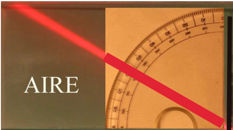
Detalle del rayo refractados en el aire
