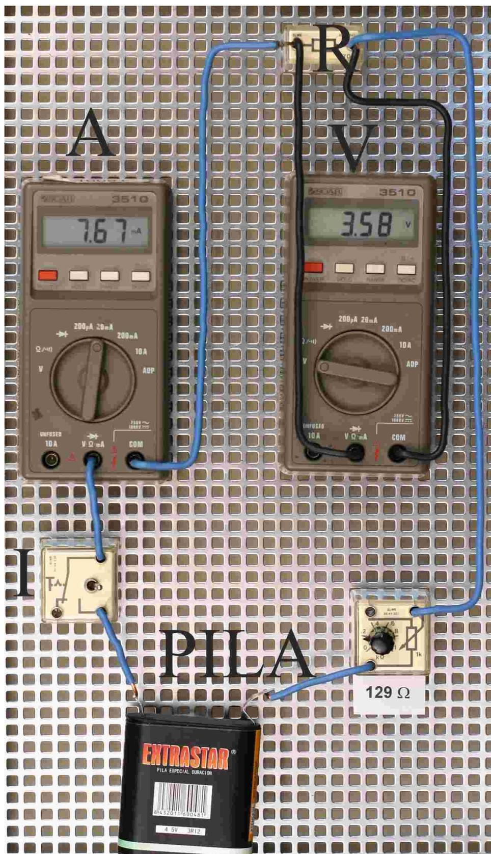
En el circuito de la figura, con una pila que no conoces el voltaje que suministra y con los datos que se toman visualmente, una vez cerrado el interruptor I, determinar:
