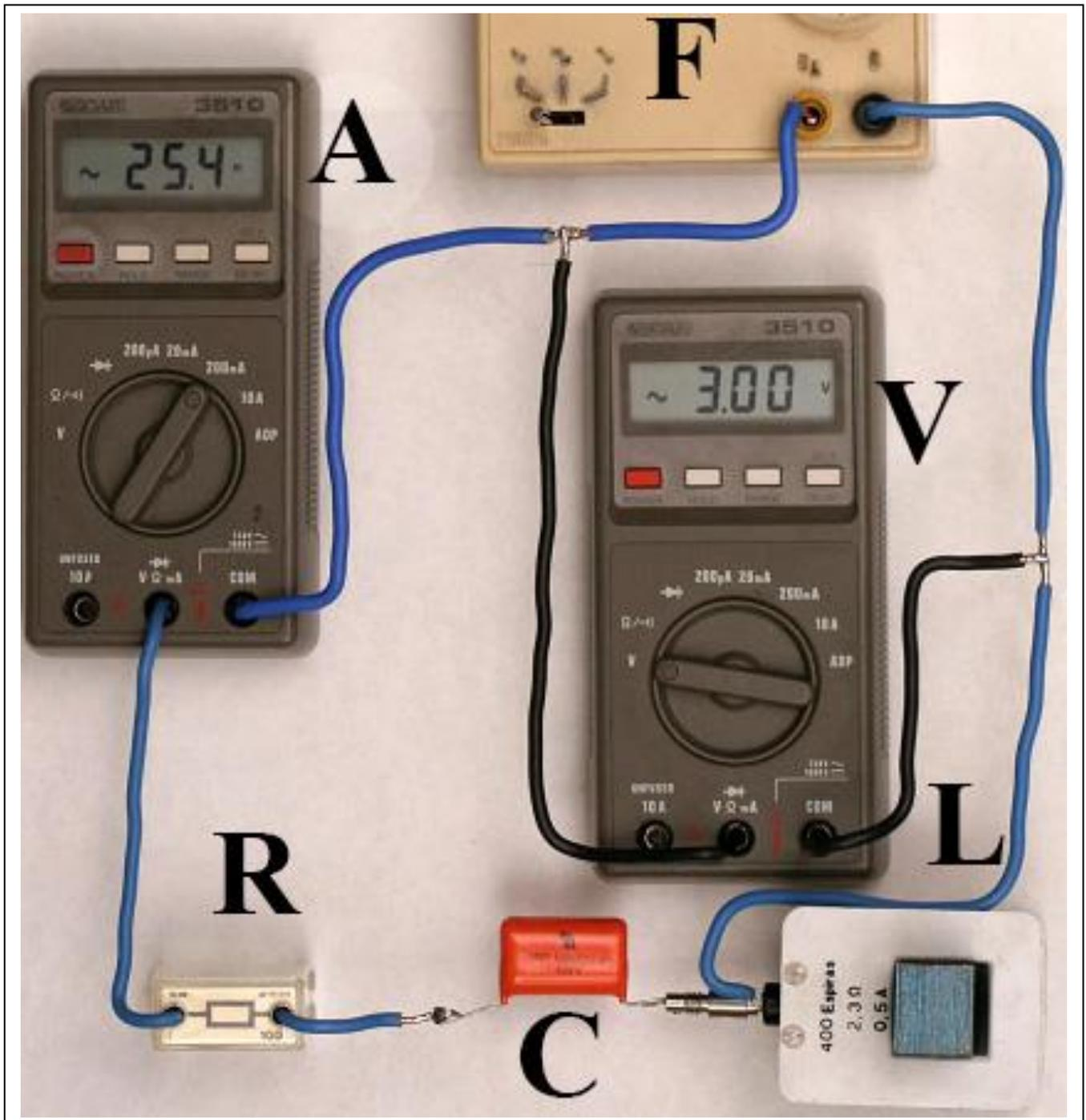
En el circuito de corriente alterna en serie presentado, se dispone de una resistencia  $R$  de  $100\Omega$ , un condensador  $C$  de  $1$  microfaradio y una bobina con una autoinducción  $L$  de  $0,02H$ , y una resistencia . El circuito se ha unido directamente a un generador de ondas sinusoidales. El circuito lleva incorporado un voltímetro y un amperímetro en la escala de los miliamperios. Con los datos de la foto, determinar:
