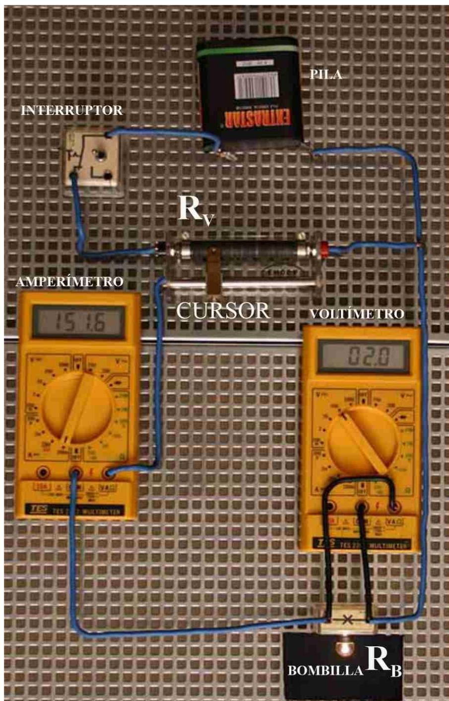
Con los datos que se dan en la foto, con una pila de 4,5V, una resistencia variable  $R_v$ , una bombilla, que implica una resistencia  $R_B$ , una vez cerrado el interruptor, determinar sus valores.
