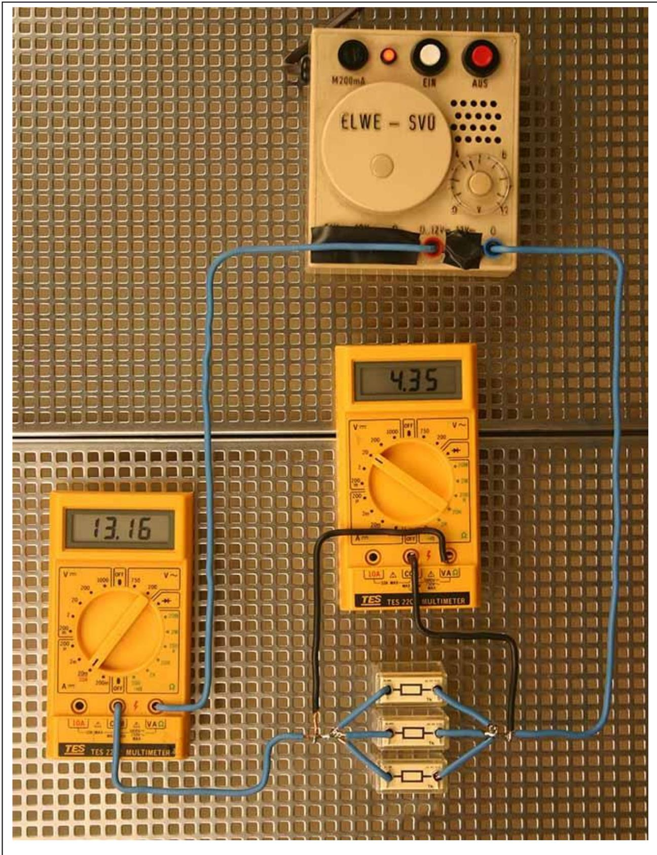
Con los datos que se dan en la foto, con una fuente variable de corriente, un amperímetro, un voltímetro y 3 resistencias iguales, determina el valor de las resistencias.
