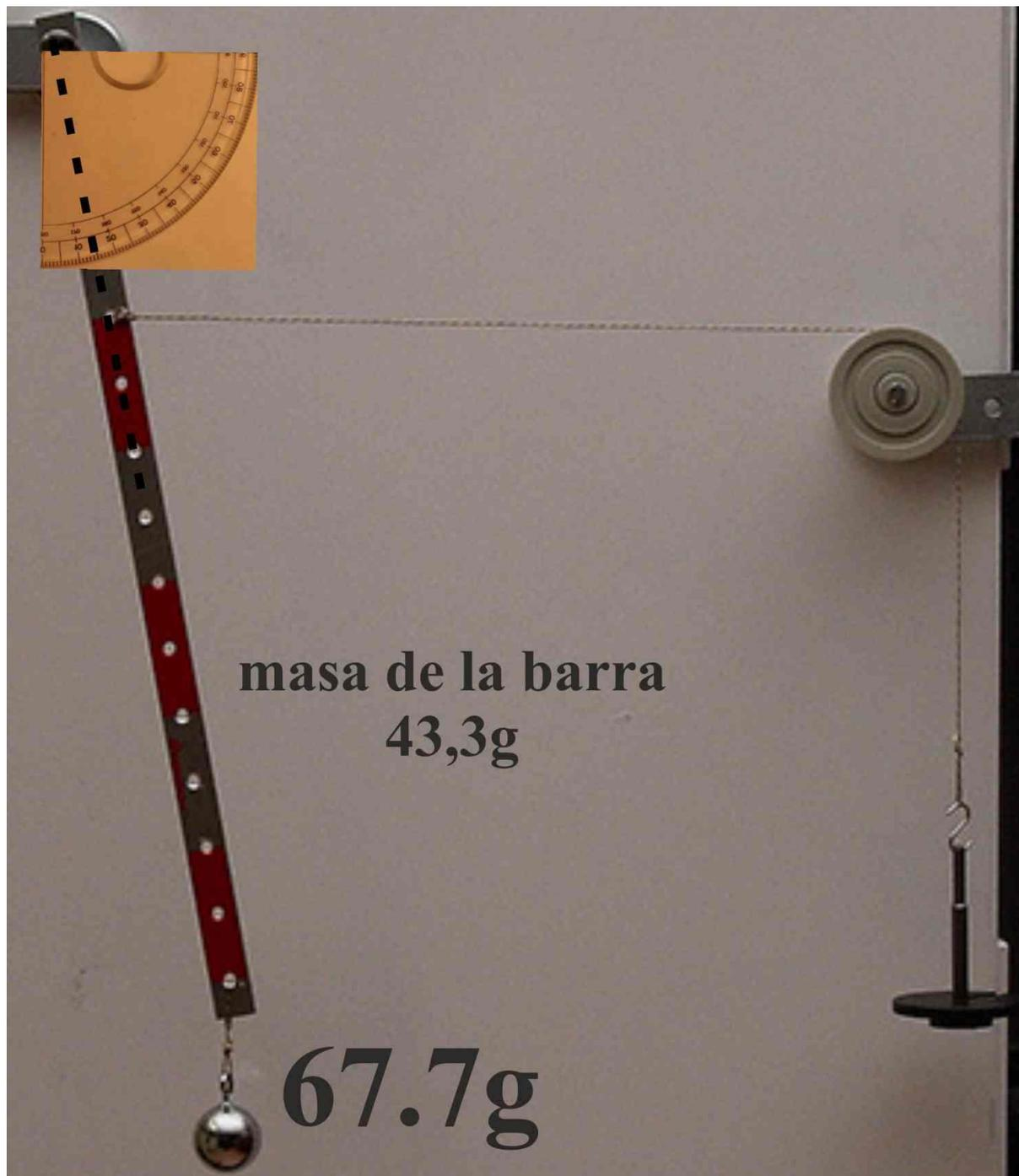
Dada la foto de la figura de un sistema en equilibrio, con la cuerda atada al quinto orificio de la palanca didáctica de 15 orificios y con los datos que te dan, determinar
