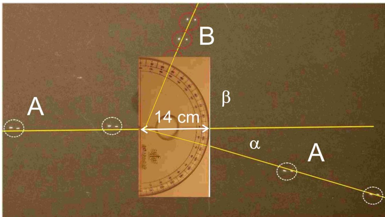
Una esfera de acero A de 110 g, se lanza sobre otra del mismo material B, que se encuentra fija. De resulta de la colisión, las dos esferas se mueven como indica la foto (la sucesión de imágenes se tomó con un intervalo de 0,069s) Teniendo en cuenta la distancia real marcada por el segmento 14 cm), y el ángulo que forman las velocidades de las esferas después de la colisión, determina:
