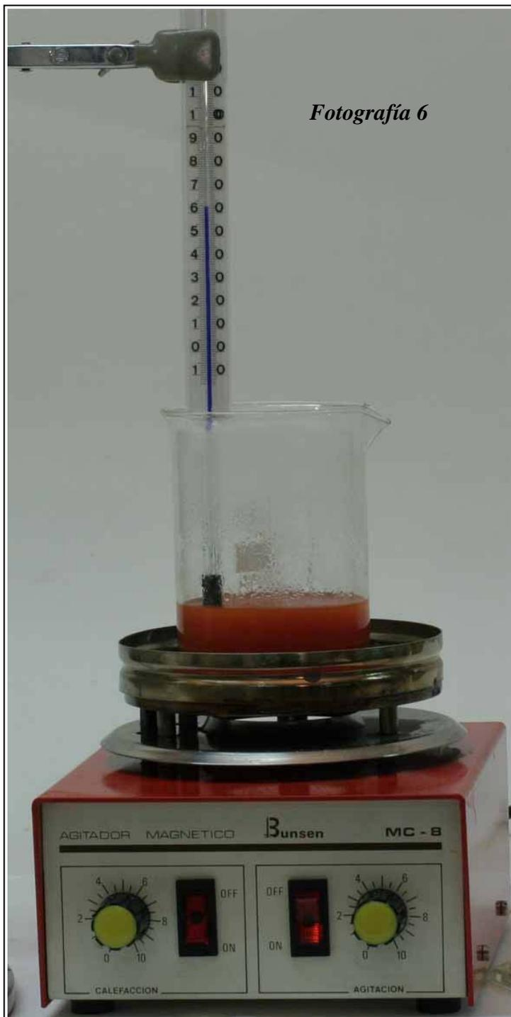
*Poco tiempo después de la anterior fotografía el color se estabiliza en un rojo intenso, sin que varíe la temperatura. A partir de aquí dejamos enfriar la mezcla hasta unos 55°C.*
