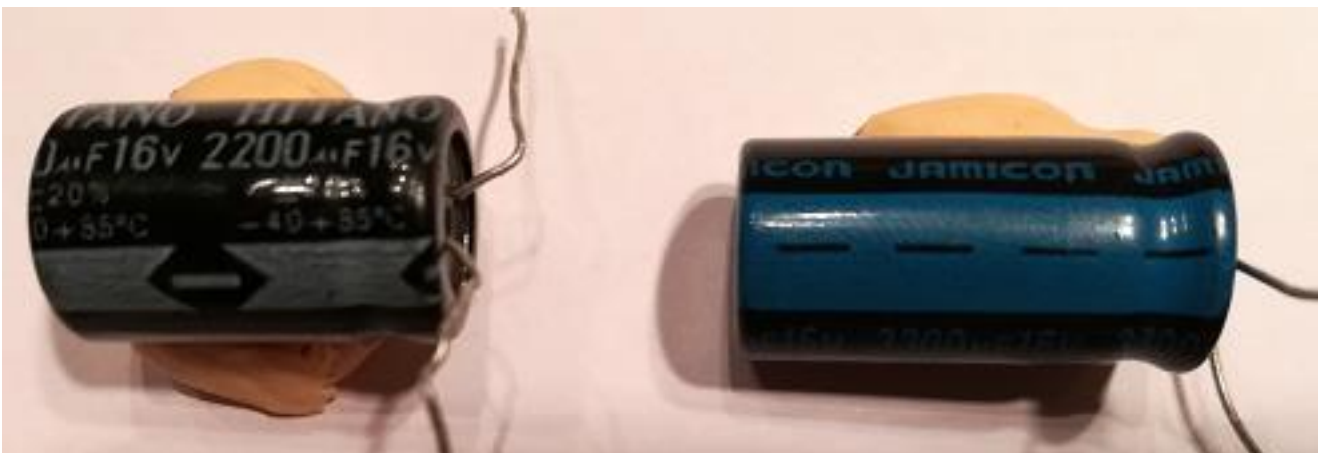
Fotografía1. El condensador de la izquierda tiene una capacidad nominal de 22000 \mu\text{F} y el de la derecha 3300 \mu\text{F} . El signo menos indica, en ambos, el polo negativo. El otro polo que no lleva señal es el positivo.
