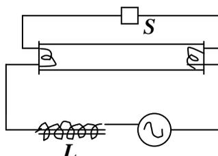
*El voltaje eficaz de la corriente alterna es 228,5 V y la intensidad eficaz 0,6 A. El voltaje eficaz entre los extremos del tubo fluorescente es 84 V y la resistencia óhmica de la autoinducción 26,3 Ω*
